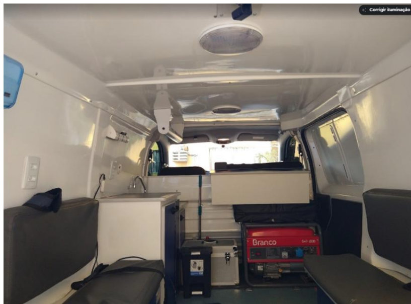
Figura 3 - Organização interna da unidade móvel. Assentos nas laterais, pia para higienização das mãos, gerador monofásico em vermelho. Fonte: autora 2021
