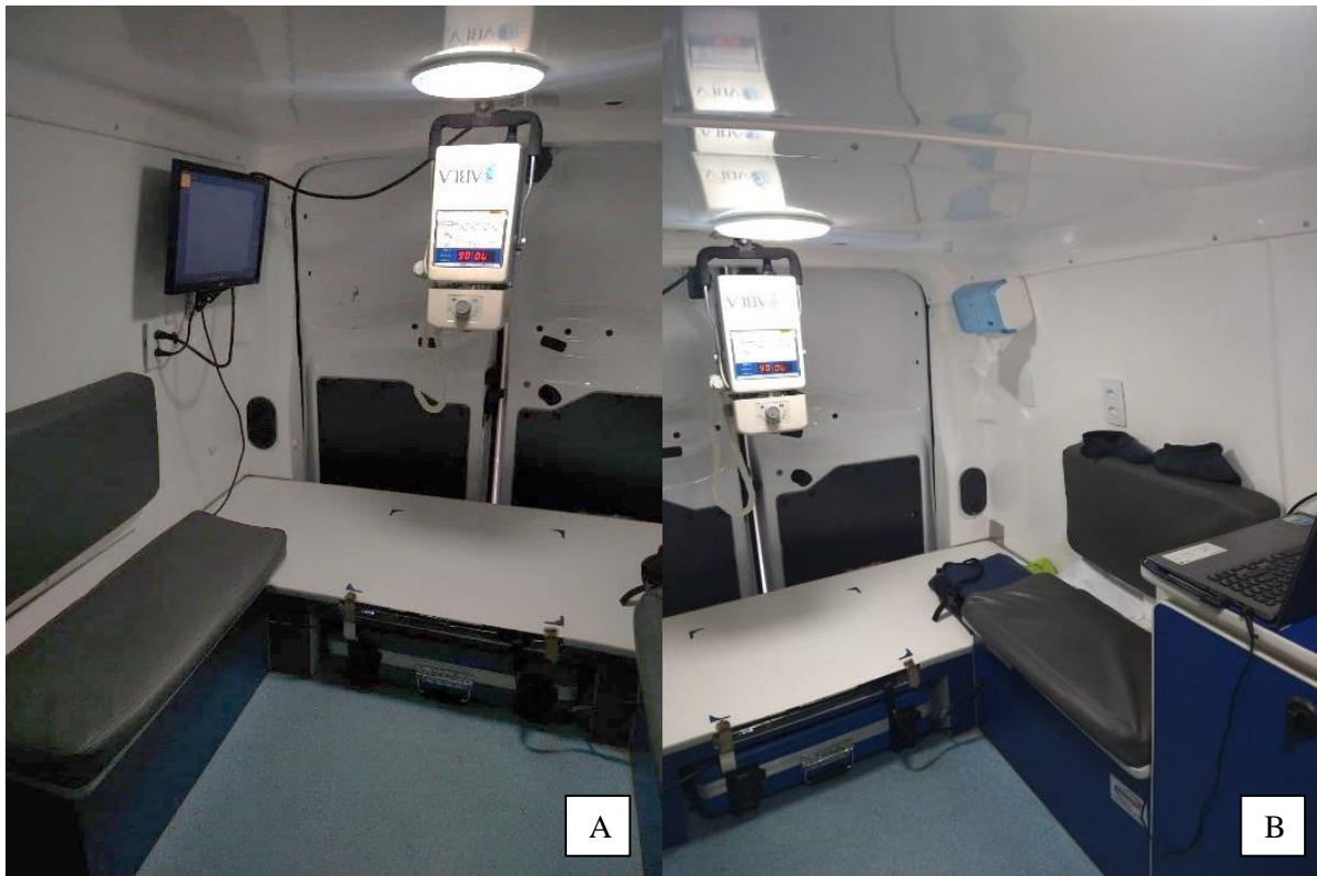
Figura 2 - Disposição das acomodações internas. Monitor lcd posicionado na lateral esquerda da imagem A; Assentos dos tutores nas laterais; mesa para manuseio dos animais; placa amplificadora situada sob a mesa; emissor ao centro preso ao teto e disposto em direção a placa.
