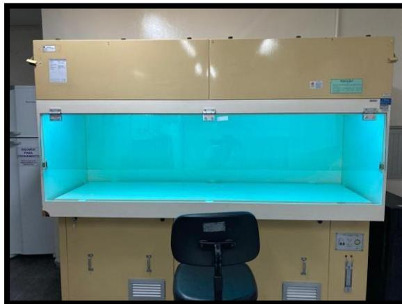
**Figura 8.** Fluxo laminar com UV ligada.
