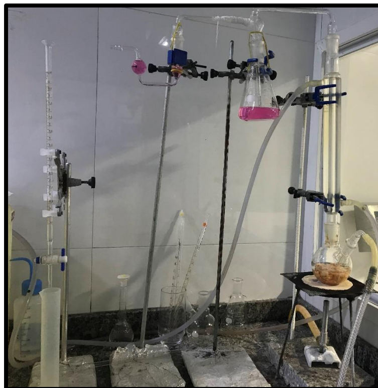
Figura 22. Método Monier-Willams (adaptado).
