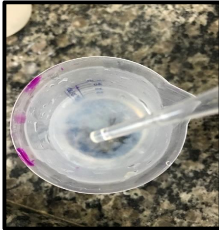
Figura 17. Amostra da água do pasteurizador sem resíduo, na borda do béquer contém resíduo do detergente.
