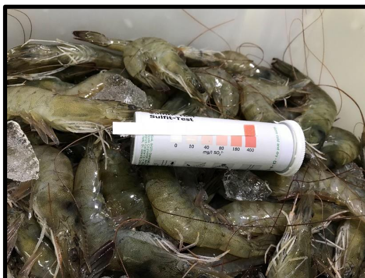
Figura 20. Análise do teor de metabisulfito utilizando a fita de Merck
