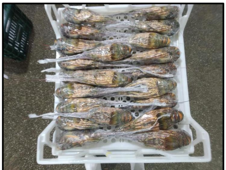
Figura 19 - Embalagem primária depois da passagem no túnel de encolhimento. (Fonte: Arquivo Pessoal, 2022).
