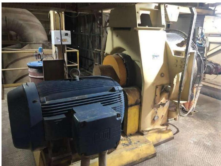
**Figura 36:** Prensa peletizadora. Fonte: Arquivo Pessoal, 2022 (Autorizado pela Empresa)
