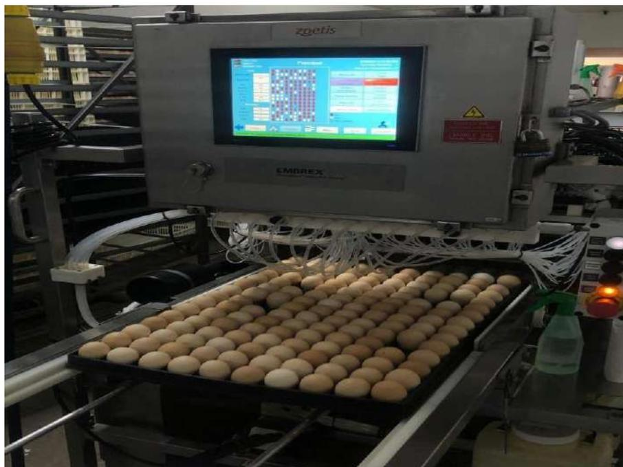
**Figura 16:** Máquina de vacinação *in ovo* . Fonte: Arquivo Pessoal, 2022 (Autorizado pela Empresa)
