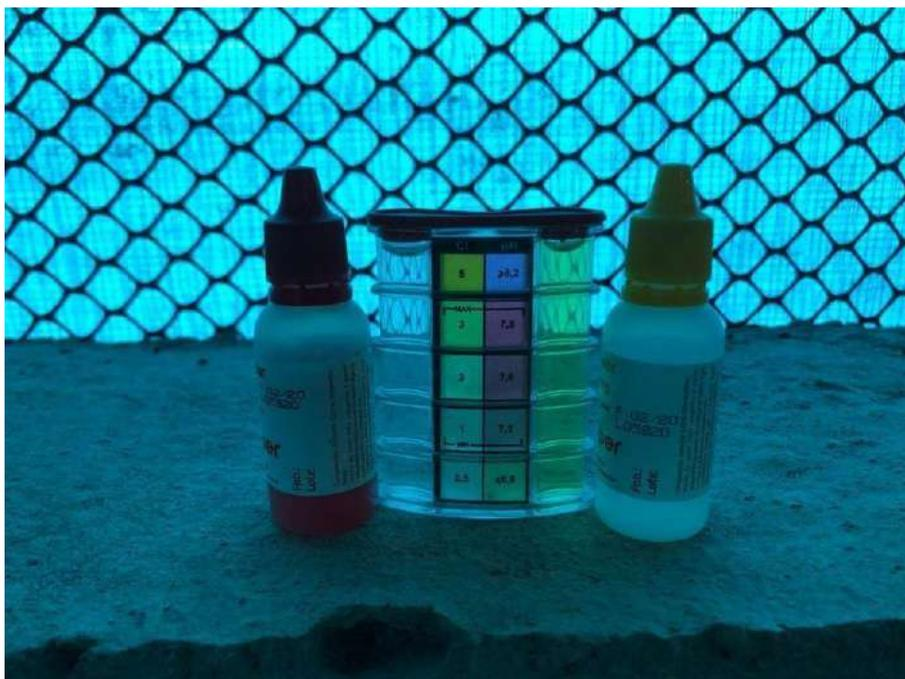
**Figura 106:** Controle Cloro e pH da água . Fonte: Arquivo Pessoal,2022 (Autorizado pela Empresa)
