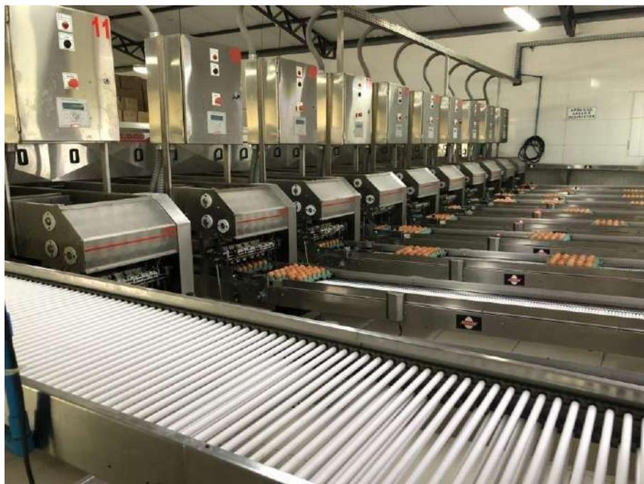
**Figura 84:** Máquina de seleção de ovos e pesagem. Fonte: Arquivo Pessoal,2022(Autorizado pela Empresa)
