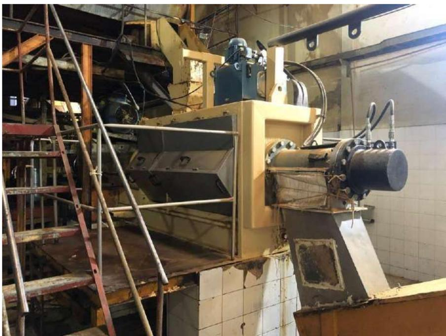
**Figura 69:** Máquina de fritura e vapor para vísceras. Fonte: Arquivo Pessoal, 2022 (Autorizado pela Empresa)
