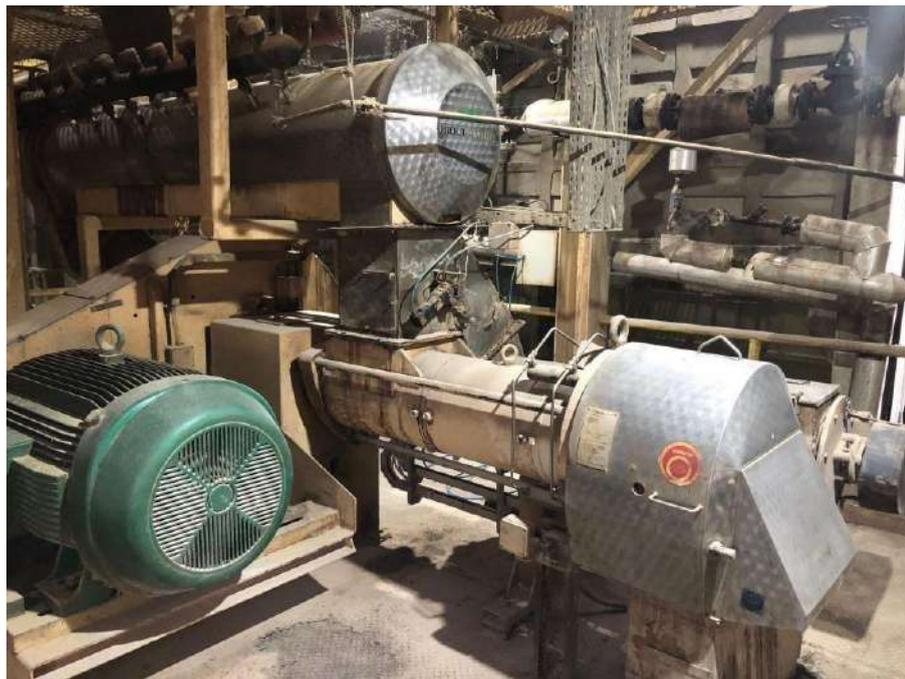
**Figura 35:** Condicionador de peletização. Fonte: Arquivo Pessoal, 2022 (Autorizado pela Empresa)
