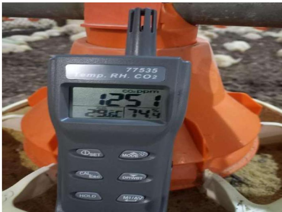
**Figura 103:** Medidor de CO<sub>2</sub>, temperatura e umidade. Fonte: Arquivo Pessoa,2022 (Autorizado pela Empresa)
