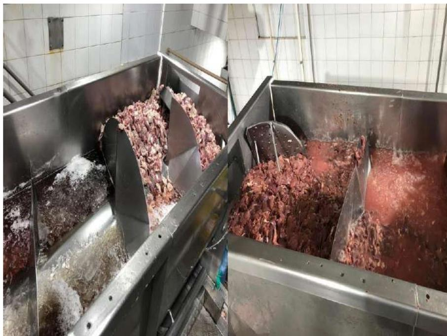
**Figura 56:** Pré-chiller e chillers específicos de miúdos.
