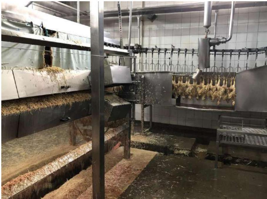
**Figura 55:** Máquina de depenação, após escaldagem. Fonte: Arquivo Pessoal, 2022 (Autorizado pela Empresa)
