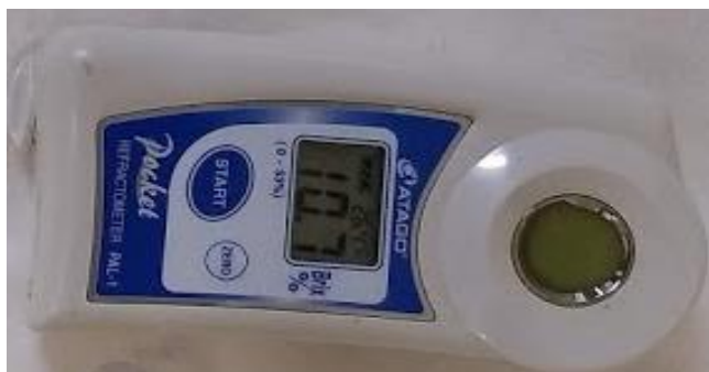
Figura 3. Determinação do teor de sólidos solúveis com auxílio de refratômetro digital. Serra Talhada, PE, 2019.
