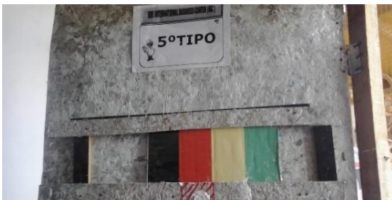
Figura 6: Ferramenta Andon localizada em todo pavimento, nas entradas da cremalheira.
