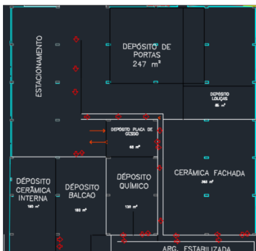
Figura 11: Layout de Canteiro do Edf. Garagem
