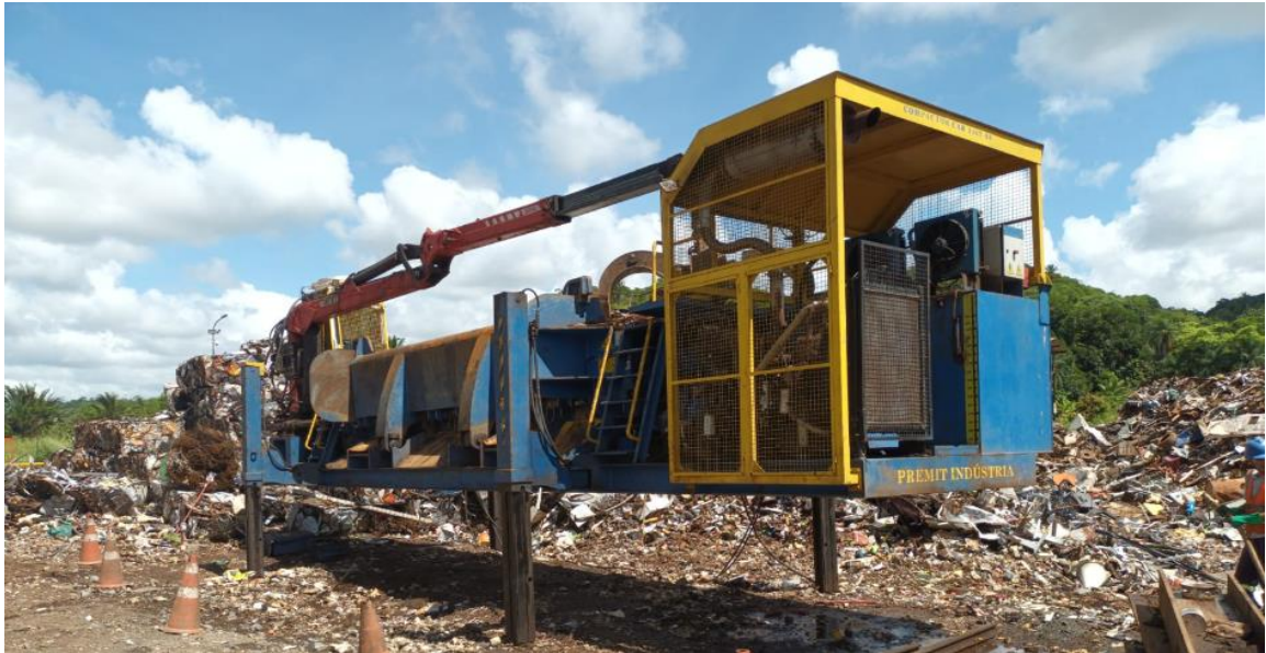
Figura 4: Prensa Hidráulica à combustão
