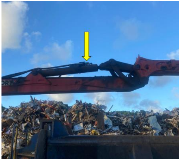
Figura 11: Válvula de retenção do cilindro de alongamento
