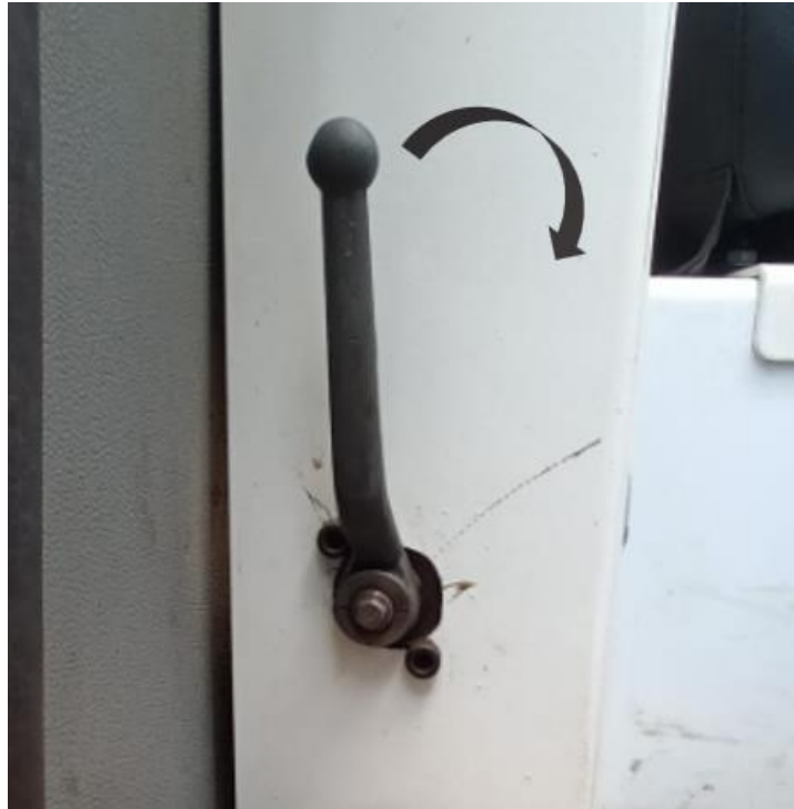
Figura 8: Válvula de descida de emergência
