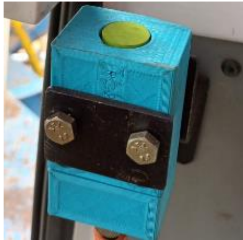
Figura 13: Sensor de abertura de porta
