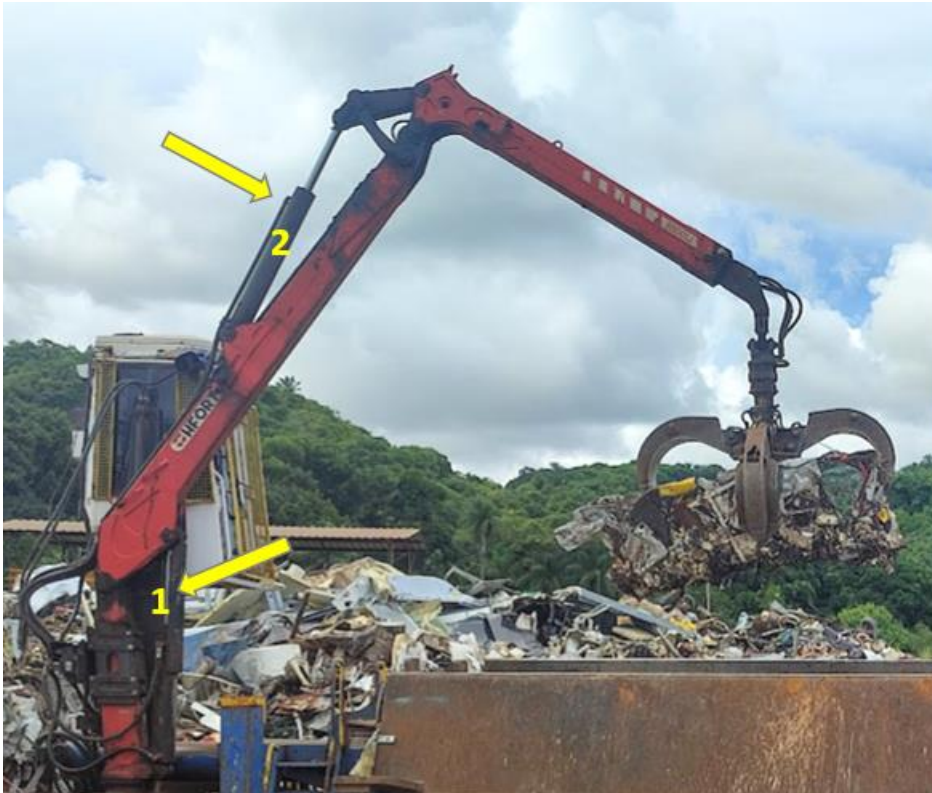
Figura 9: Cilindro do Guindaste
