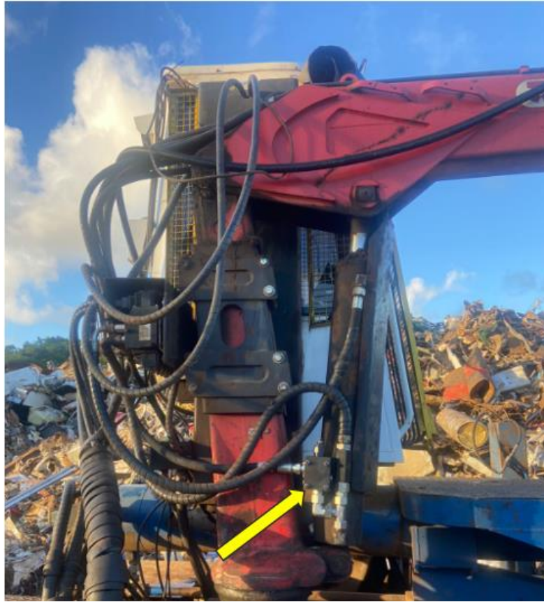
Figura 10: Retenção do cilindro de elevação
