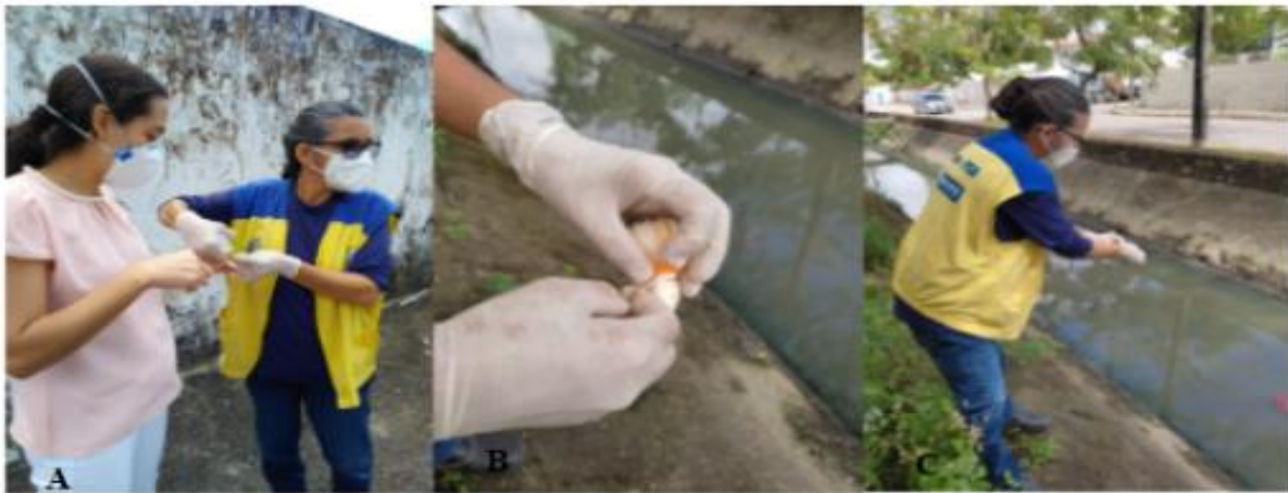
Figura 10 - (A) Preparação da “mecha” para captura de amostra de água do Córrego na Encruzilhada (B) e (C).
