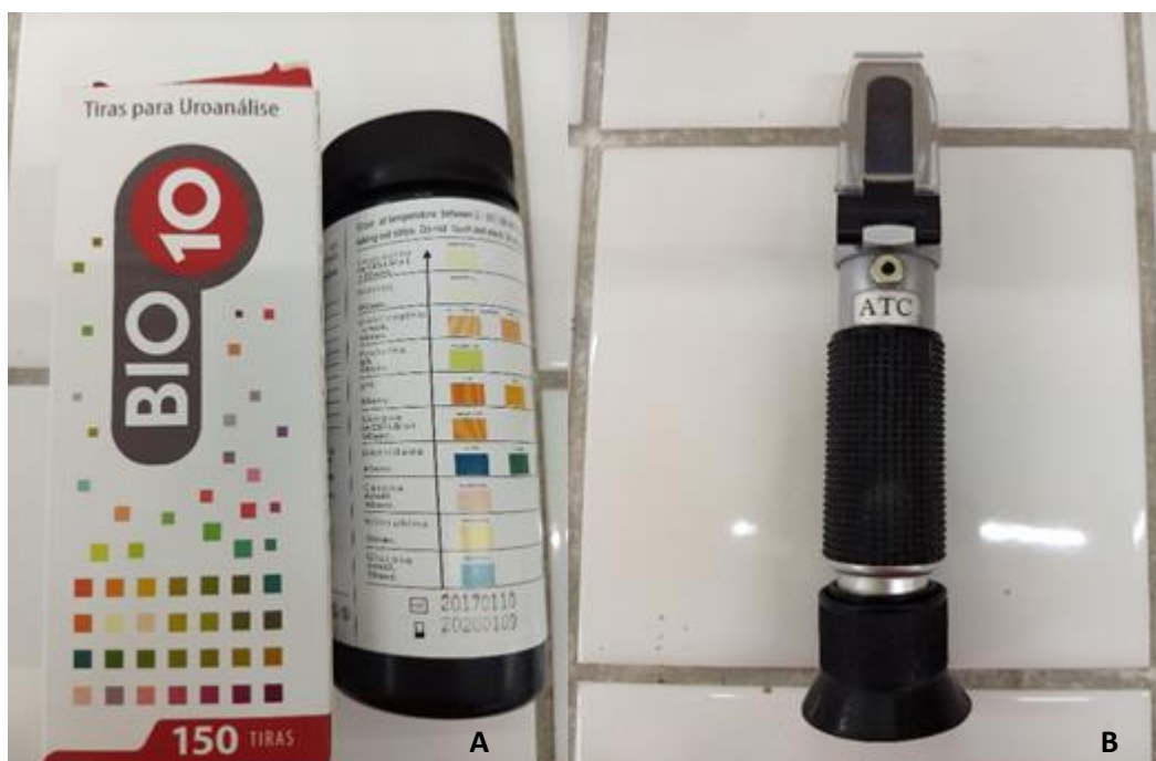
Figura 3. A- Tiras de reagentes para urinalise Biocon10 B – Refratômetro ATC
