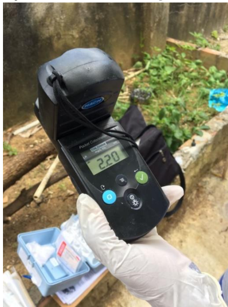
Figura 11: Aferição de cloro residual da água com colorímetro digital
