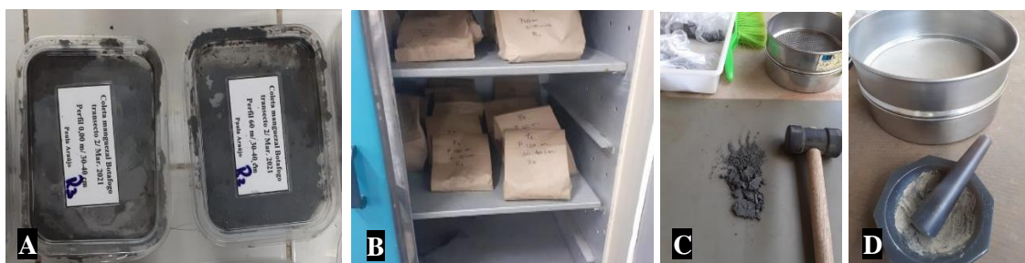
Figura 2. Preparo de amostras para análise de metais. A) Armazenamento das amostras em freezer. B) Secagem de subamostras em estufa a 35° C) Destorroamento e peneiramento (2 mm). D) Maceração e peneiramento (0,075 mm).
