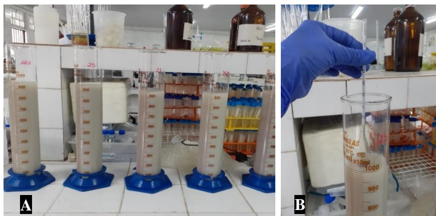
Figura 5. Análise granulométrica. A) dispersão das amostras de solo; B) determinação pelo método do densímetro.
