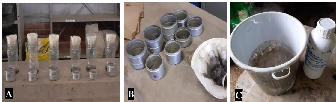
Figura 3. Pré-tratamentos: remoção de sais das amostras de solo com álcool a 60%. B) amostras após remoção dos sais com solução de álcool a 60%. C) remoção da matéria orgânica das amostras de solo com peróxido de hidrogênio a 15%.
