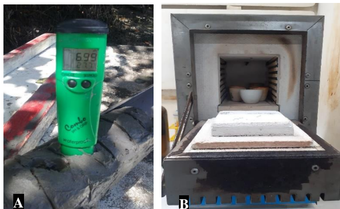
Figura 4. Caracterização química e física de amostras. A) medição de pH e Eh com equipamento de potencial de oxidação-redução (ORP) em campo. B) Cadinhos com amostras de solo em mufla.
