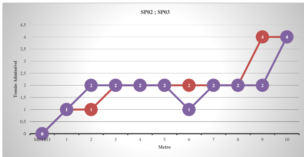
Figura 09 – Relação tensão admissível entre os SPT SP02 e SP03.
