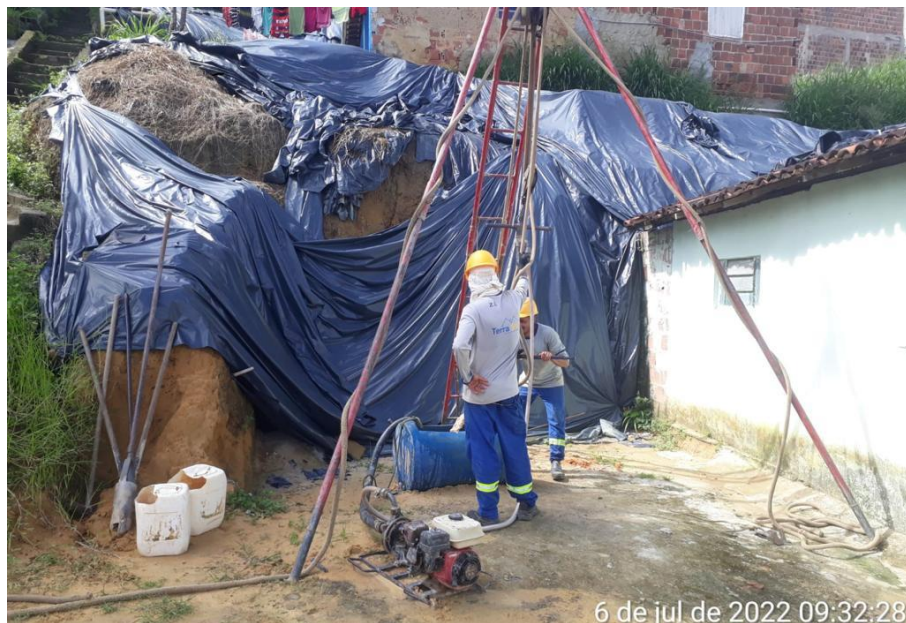
Figura 04 – Ensaio manual de SPT.
