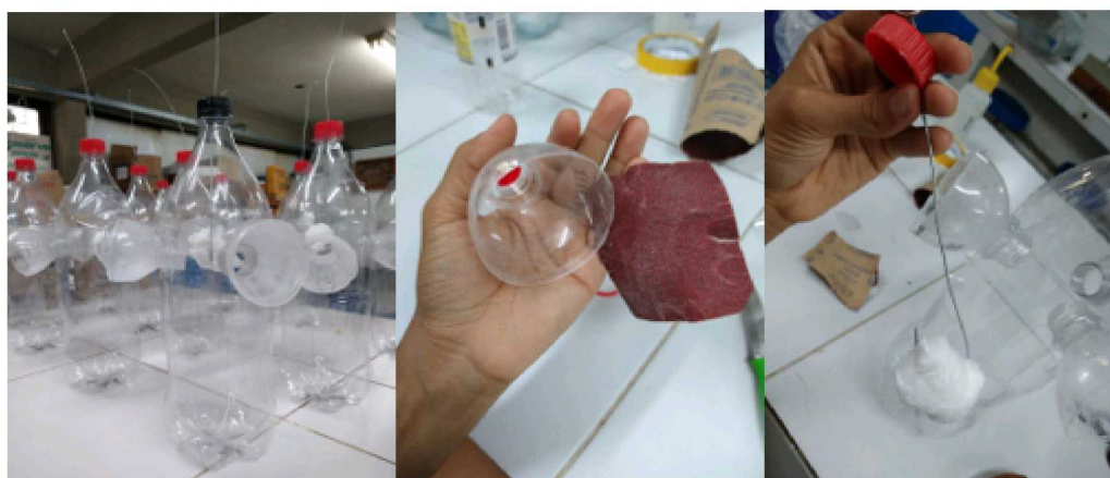
Figura 3 - Armadilha com garrafa PET elaborada manualmente para amostragem de apifauna em Caatinga, Caruaru - PE.
