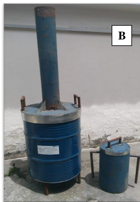
Figura 1. Modelo adaptado de forno para produção de biochar (A); Forno produzido utilizado para montagem do experimento (B).
