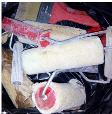
Figura 21: Pincéis e Rolos de pintura, usados no processo de acabamento das pás eólicas
