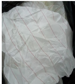
Figura 15: Debag, material constituído por plásticos, fibra de vidro e resina.
