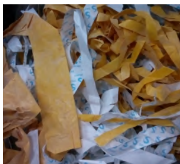
Figura 19: Paperline, material utilizado nos rolos de resina para separação de camadas.
