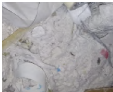
Figura 29: Pó de Varrição contaminado com materiais plásticos, proveniente da varrição do piso após processo de lixamento da pá eólica.
