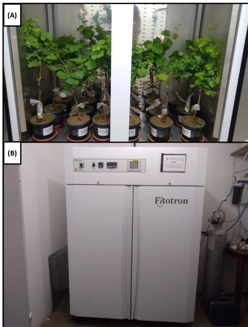
Figura 3. Transferência das mudas para a câmara climática FITOTRON (SGC 120). Letras destacadas representam: (A) transferência das mudas de videira para a câmara climática; (B) lado externo da câmara climática FITOTRON (SGC 120), equipamento no qual o experimento com videiras enxertadas foi realizado.
