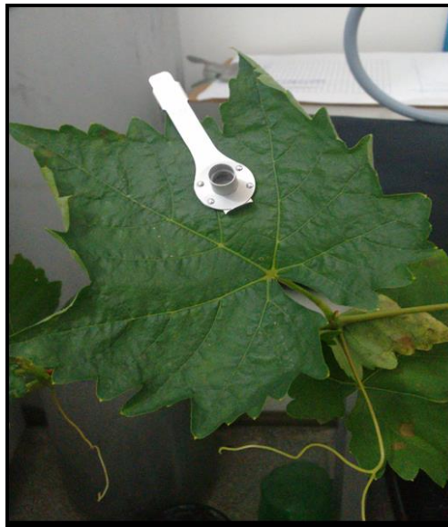
Figura 4. Pré-aclimação de folhas isoladas de videira enxertada para as medidas de atividade fotoquímica.
