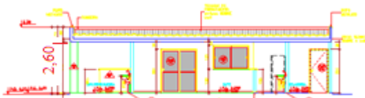
Figura 2 – Corte AA da planta baixa do salão de festas de blocos de concreto.
