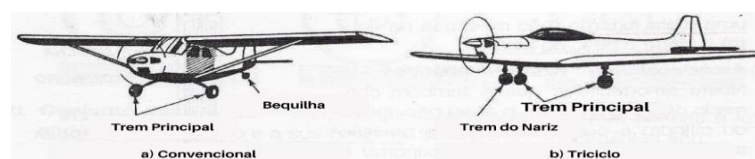
Figura 04 – Classificação do trem de pouso conforme a disposição das rodas.
