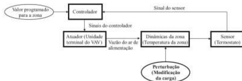
Figura 8: Diagrama de controle em sistemas realimentados
