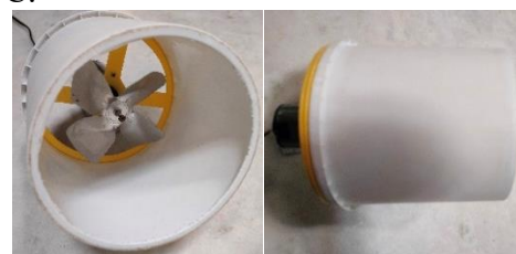
Figura 11 – Conjunto do atuador no tubo PVC.
