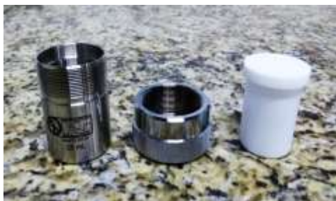
Figura 11. Reator hidrotermal, a esquerda, e o recipiente de teflon devidamente fechado, a direita.
