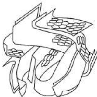
Figura 6. Estrutura do carvão ativado.
