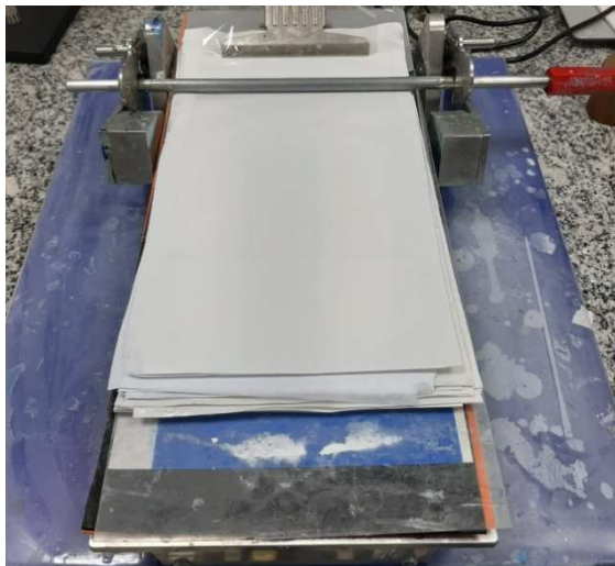
Figura 1 - máquina de revestimento manual Hand Coater RK Print.
