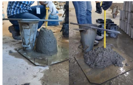
Figura 2 - Ensaio de consistência: a) verificação de abatimento do traço SS. b) verificação de abatimento do traço CS10.
