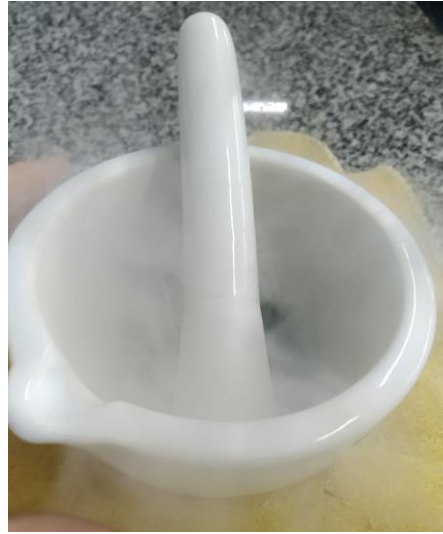
Figura 9 - Almofariz e pistilo com material fracionado e hidrogênio líquido Fonte: Coleção pessoal
