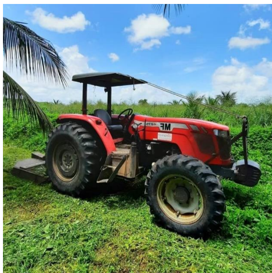
Figura 6- Trator com roçadeira acopada.
