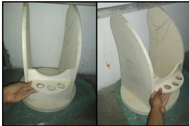
Figura 30 – Base dobsoniana amadora em fase de construção
