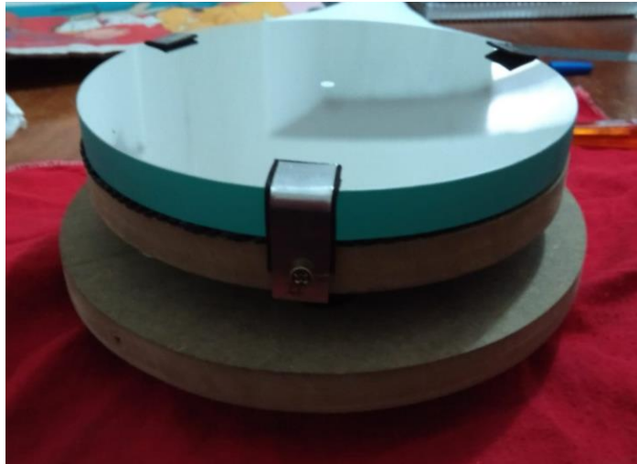
Figura 10 – Espelho primário acoplado em seu suporte
