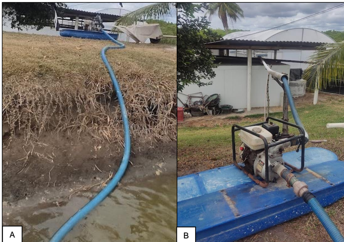
Figura 11 - A- Transferência de água do viveiro para o berçário; B- Motobomba a combustão.
