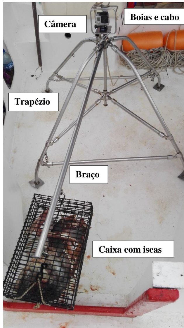
Figura 2: Estrutura dos BRUVs utilizados para monitorar a ictiofauna no arquipélago de São Pedro e São Paulo, Brasil. Imagem: Natalia Bezerra.
