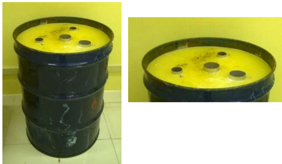
Figura 11. Câmara para suporte da fonte de Nêutrons AmBe localizada no departamento de metrologia (CRCN/NE). Câmara consiste em tonel de aço contendo 4 tubos de alumínio suportados por parafina.
