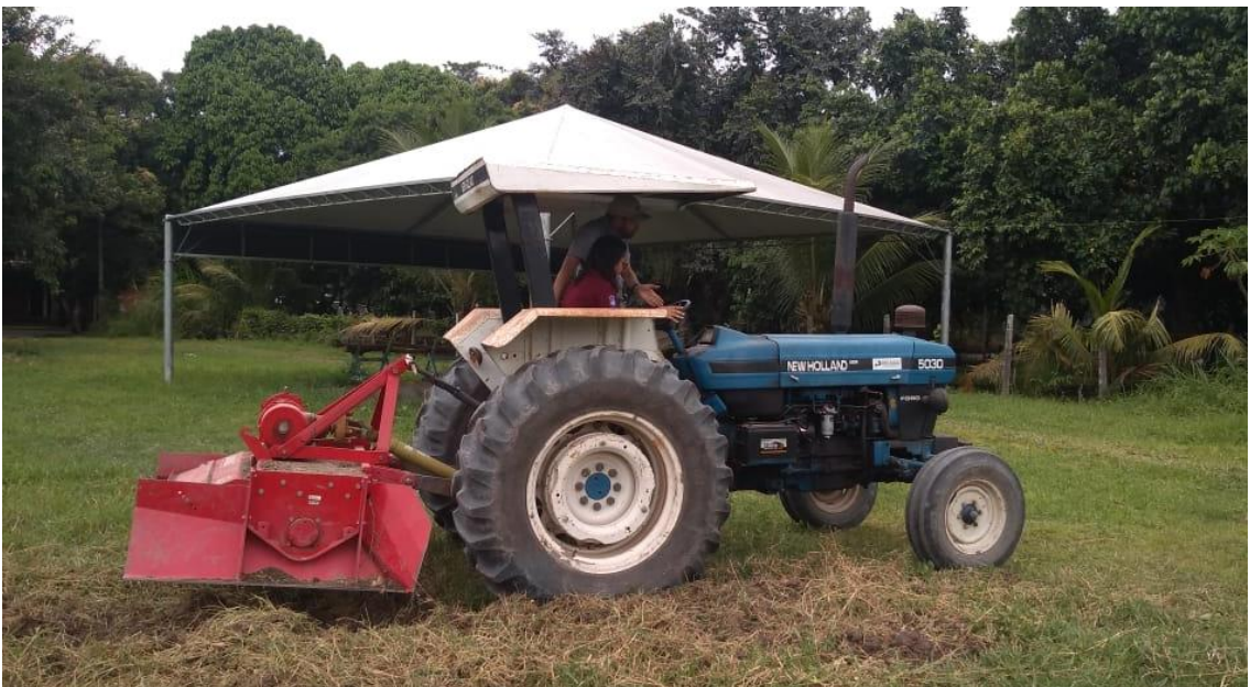
Figura 27 - Rotoencanteirador atrelado ao sistema hidráulico do trator (Recife-PE). Fonte: Arquivo Pessoal.
