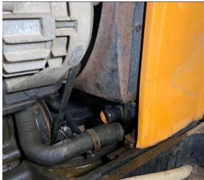
Figura 11 - Drenagem do líquido do radiador (Recife-PE). Fonte: Arquivo Pessoal
