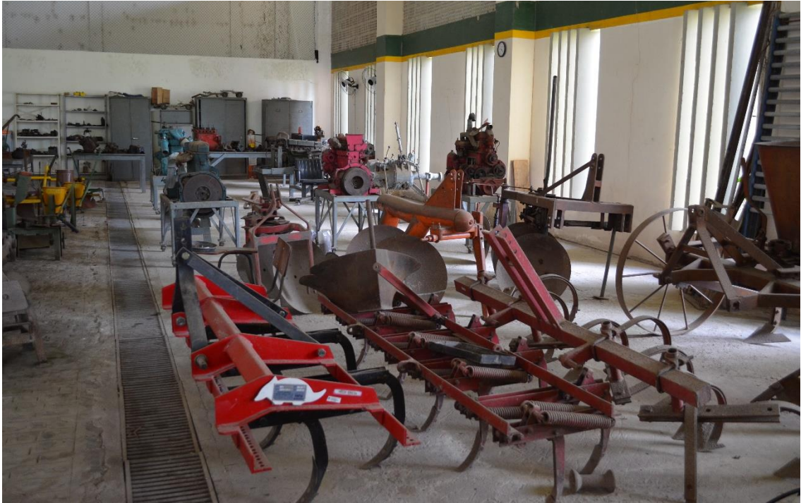
Figura 26 - Cultivadores tratorizados, todos montados no sistema hidráulico (Recife-PE). Fonte: Arquivo Pessoal.
