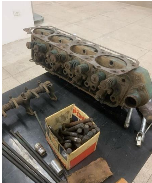
Figura 6 - Cabeçote do motor desmontado (Recife-PE). Fonte: Arquivo Pessoal.
