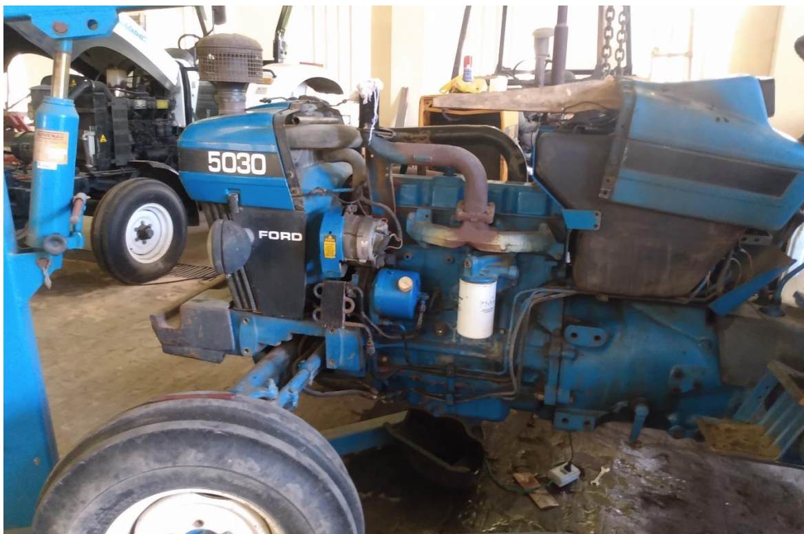
Figura 15 - Manutenção do sistema de alimentação do New Holland 5030 (Recife-PE). Fonte: Arquivo Pessoal.
