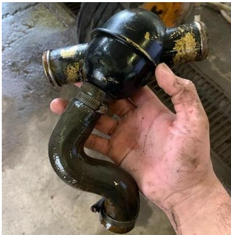
Figura 12 - Válvula termostática do trator Valmet 78 (Recife-PE). Fonte: Arquivo Pessoal.
