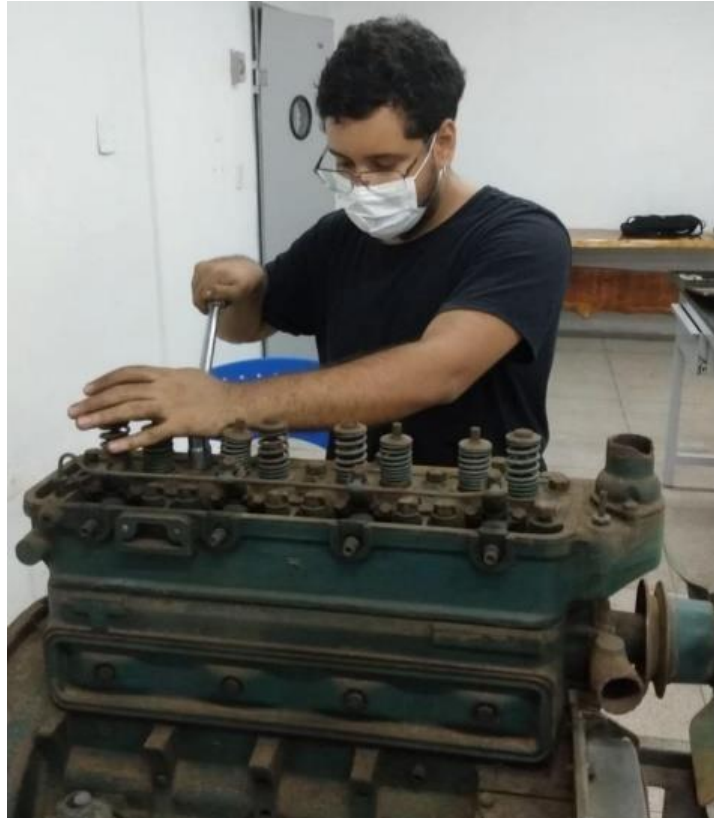
Figura 5 - Desmontando o cabeçote do motor para reforma (Recife-PE). Fonte: Arquivo Pessoal.
