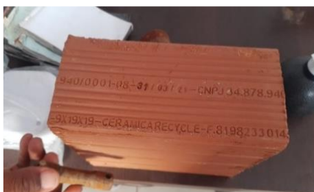
Figura 7: Tijolo produzido com o resíduo de terra clarificante
