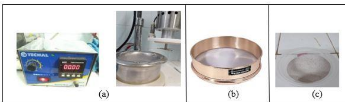
Figura 1: (a) Moinho de facas, (b) peneira granulométrica 70 MESH e (c) material triturado e peneirado.
