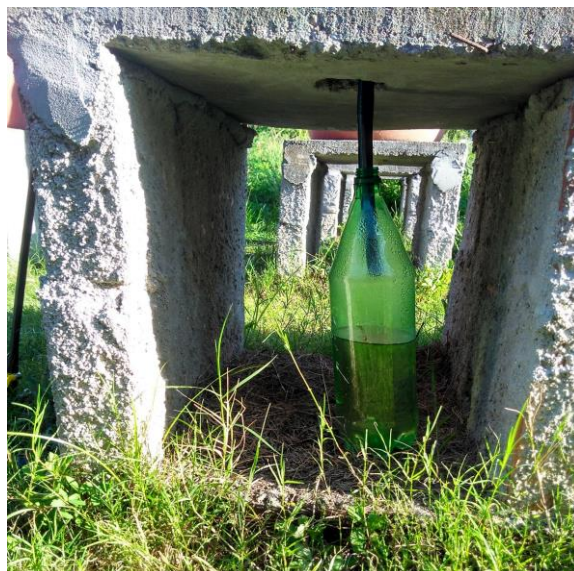
Figura 5. Mangueira conectada a garrafa PET, componentes armazenadores do sistema de drenagem dos lisímetros.
