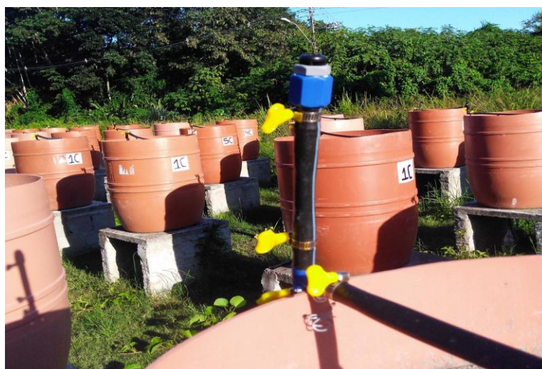
Figura 11. Válvula antivácuo disposta no sistema de irrigação do lisímetro.
