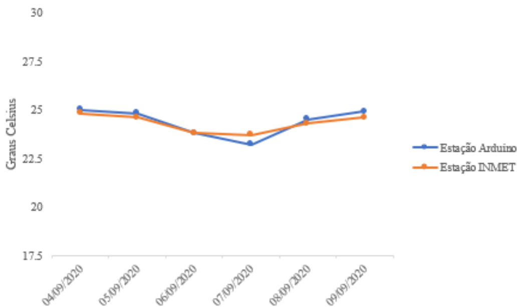
Figura 4. Temperatura média medida pela estação Arduino e pela estação INMET. Fonte: Acervo pessoal do autor.
