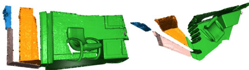
Figura 9 – Nuvem de Pontos Quarto Segmentada pelo DBSCAN
