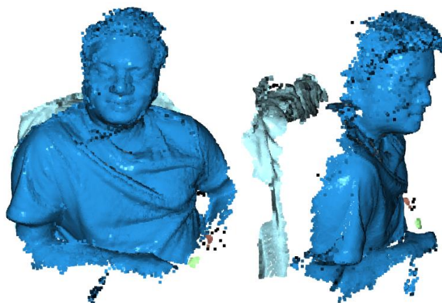
Figura 11- Nuvem de pontos Guy Segmentada pelo DBSCAN
