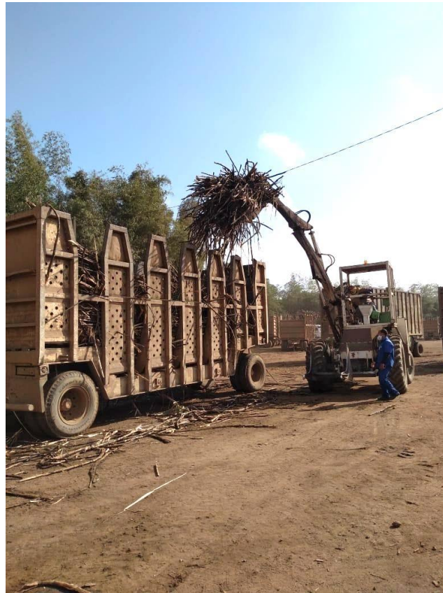
Figura 42. Carregadeira convencional realizando o carregamento do reboque.
