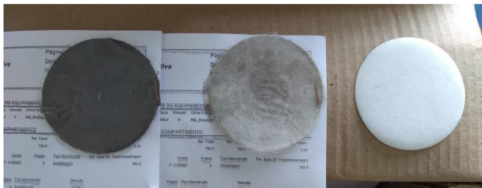
Figura 56. Resultado da análise da presença de partículas metálicas no fluido. O disco a direita representa uma amostra em branco.
