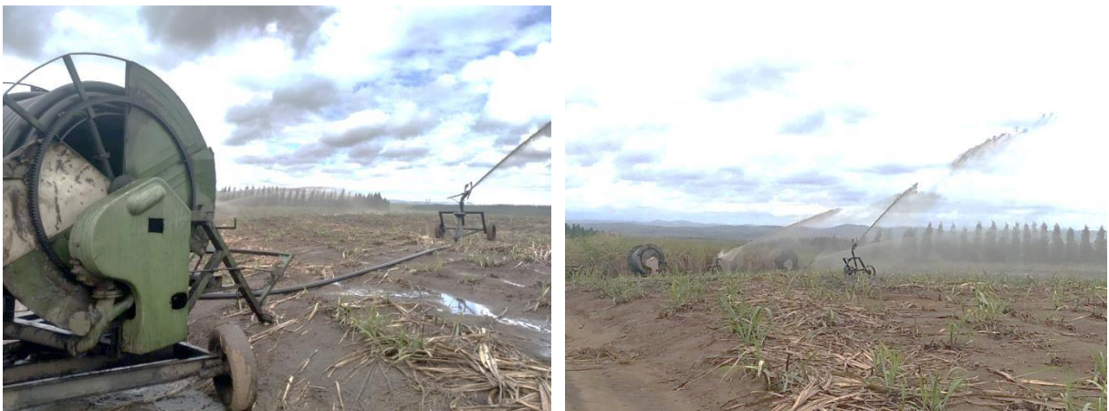
Figura 38. Aplicação de vinhaça pelo sistema de carretel (autopropelido).
