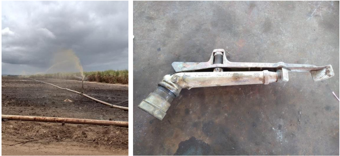
Figura 37. Aplicação de vinhaça por aspersão. Aspersor Plona ® KI 2500.
