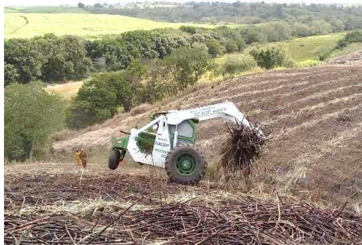
Figura 43. Carregadora Bell realizando o tombamento da cana.
