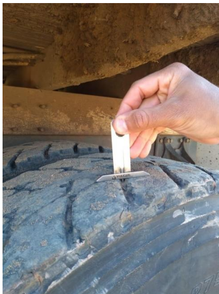
Figura 57. Medição dos sulcos com o profundímetro.
