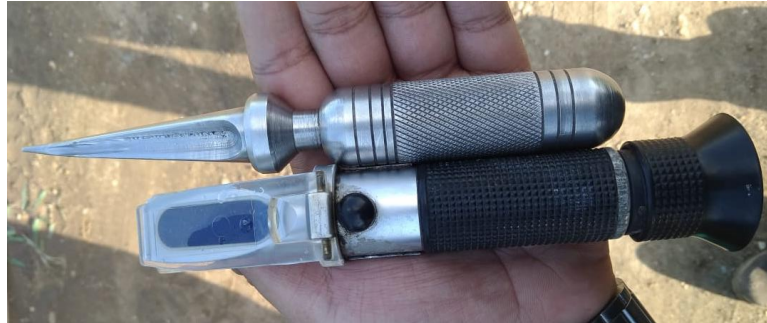
Figura 15. Ferramenta para coleta de amostra e refratômetro. Fonte: Do autor
