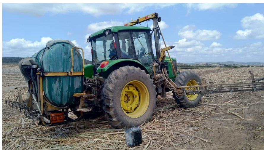
Figura 9. Herbplus, implemento para aplicação mecanizada de herbicida. Fonte: Do autor
