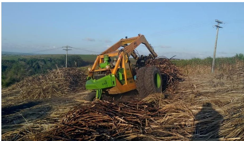
Figura 19. Máquina Bell "tombando" a cana. Fonte: Do autor
