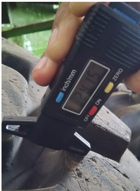
Figura 23. Equipamento utilizado para medição do sulco do pneu. Fonte: Do autor.
