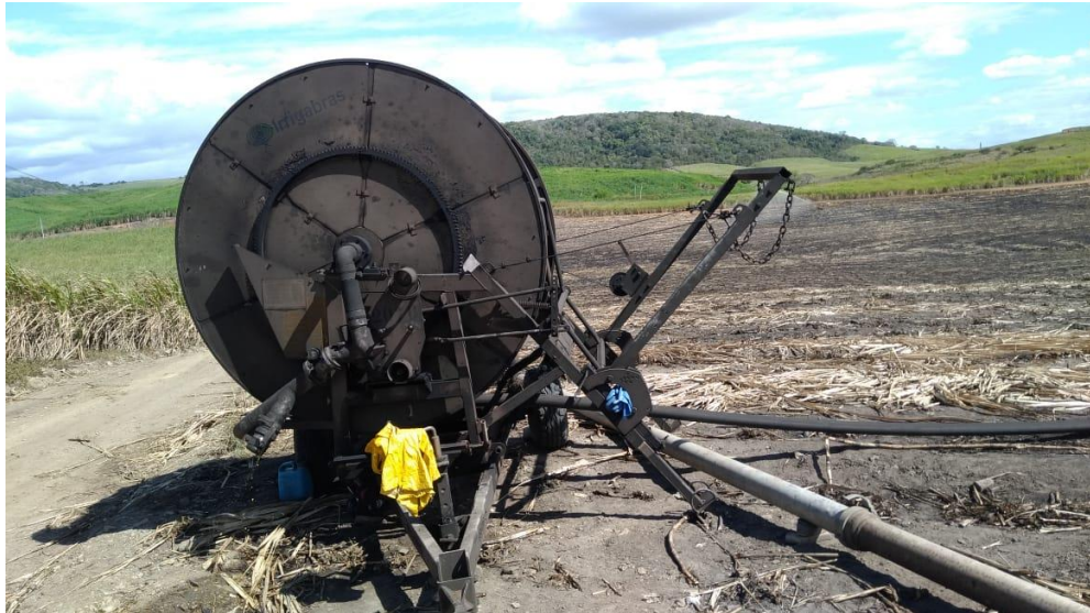
Figura 14. Sistema de irrigação com vinhaça por aspersão utilizando autopropelido. Fonte: Do autor
