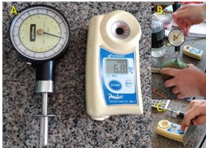
Figura 5: [A] Penetrômetro e refratômetro digital, respectivamente; [B] Análise de firmeza da polpa; [C] medição do brix.
