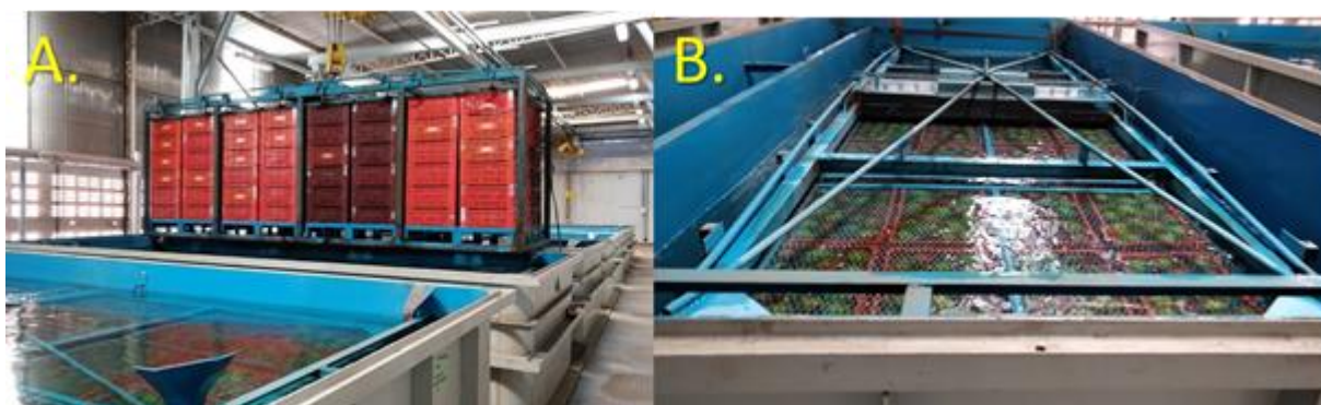
Figura 11: [A] Imersão da gaiola calibre 07 no tanque hidrotérmico; [B] Tratamento hidrotérmico.
