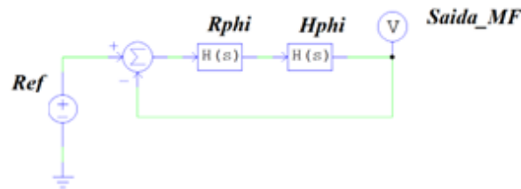
Figura 48 - Controle do eixo em quadratura sem a malha interna
