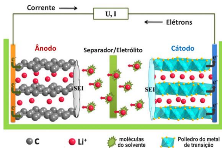
Figura 7 — Funcionamento de uma bateria de lítio
