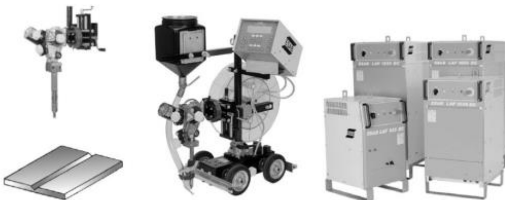
Figura 5 - Componentes básicos de soldagem por arco submerso
