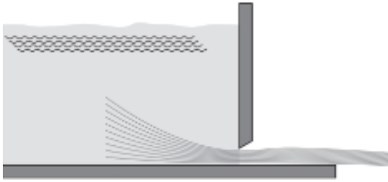
Figura 11 – Orifício de saída do reservatório.
