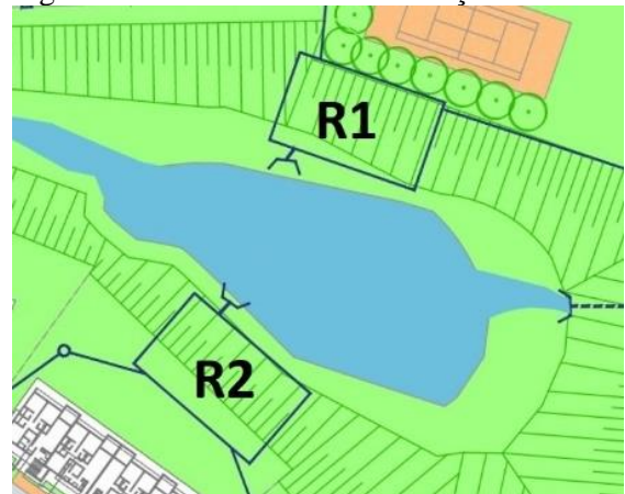
Figura 18– Reservatórios de detenção.
