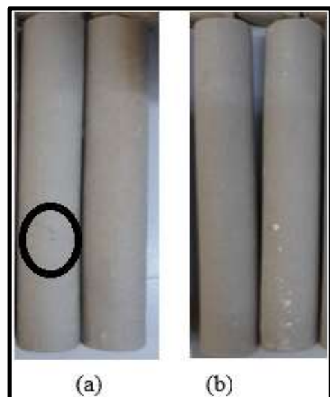
Figura 8- Corpo de provas sinterizado (a) Lodo (b) Barbotina virgem.
