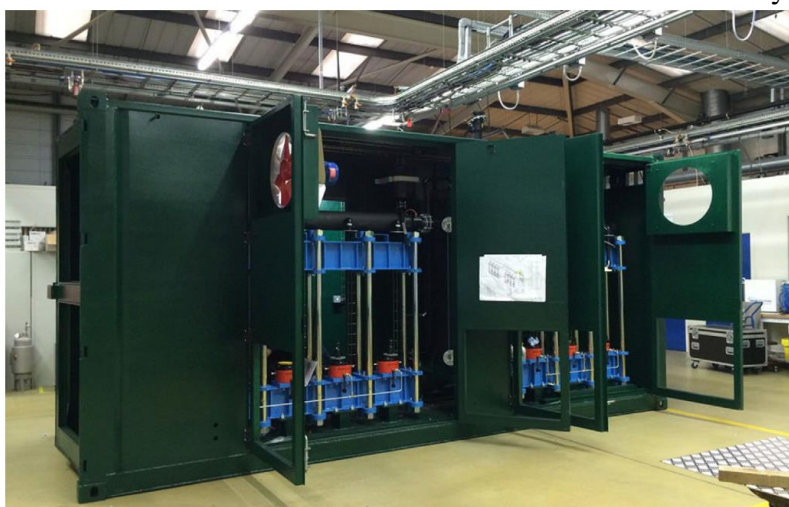
Figura 18 - Eletrolisador PEM da ITM Power instalado em Orkney.
