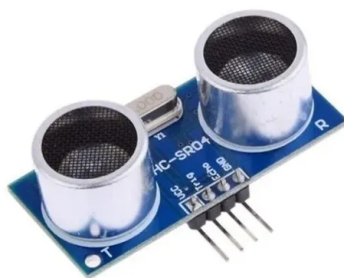
Figura 10 – Módulo HC-SR04, Fonte: https://www.filipeflop.com .
