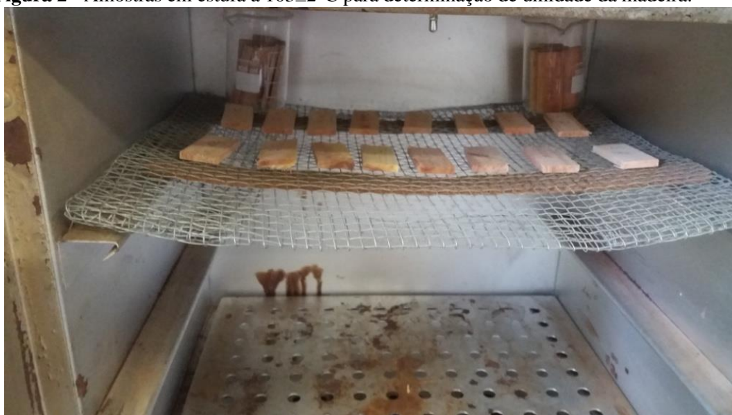
Figura 2 - Amostras em estufa a 103\pm 2^{\circ}\text{C} para determinação de umidade da madeira.
