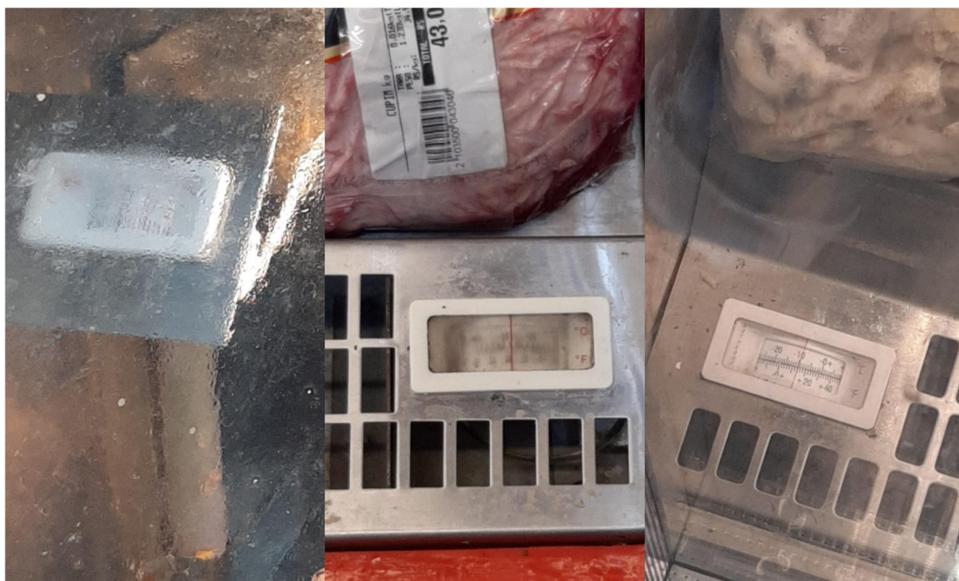
Figura 2 – Termômetro dos balcões frigoríficos.
