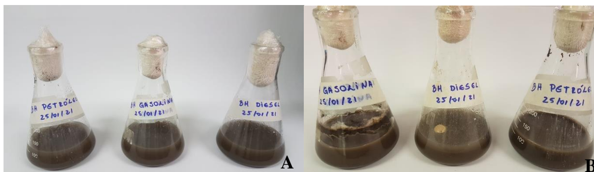
Figura 6. Determinação das bactérias hidrocarbonoclásticas de sedimento de mangue em meio BH contendo petróleo, gasolina e óleo diesel. Aspecto macroscópico dos frascos Erlenmeyer prontos para incubação em shaker a 180 rpm e 28 °C (A) e após 8 dias de incubação (B).
