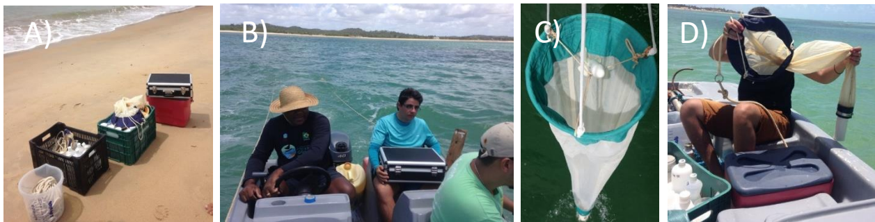
Figura 1 - Etapa de campo: A) Materiais utilizados para coleta, B) Arrasto de rede de plâncton, C) Rede de plâncton, D) Rede sendo retirada da água.
